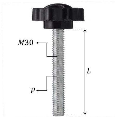
Imagen 57. Características geométricas del tornillo con perilla.
