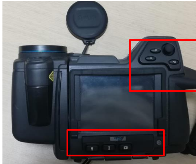
Figura 10 Controles cámara termográfica FLIR T440.
