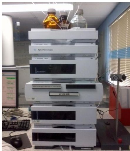
Figura 15. Cromatógrafo líquido Agilent Technologies 1200 Series . Fotografía tomada por la autora en el CENIVAM, UIS-Bucaramanga, 20 de enero de 2013.
