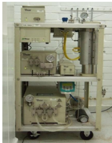
Figura 10. Equipo de extracción con fluido supercrítico Thar SFE-2000 . Fotografía tomada por la autora en el CENIVAM, UIS-Bucaramanga, 10 de febrero de 2012.
