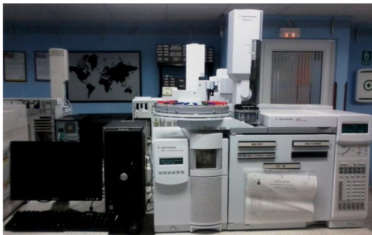
Figura 13. Cromatógrafo de gases Agilent Technologies 6890N Network GC System . Fotografía tomada por la autora en el CENIVAM, UIS-Bucaramanga, 20 de enero de 2013.
