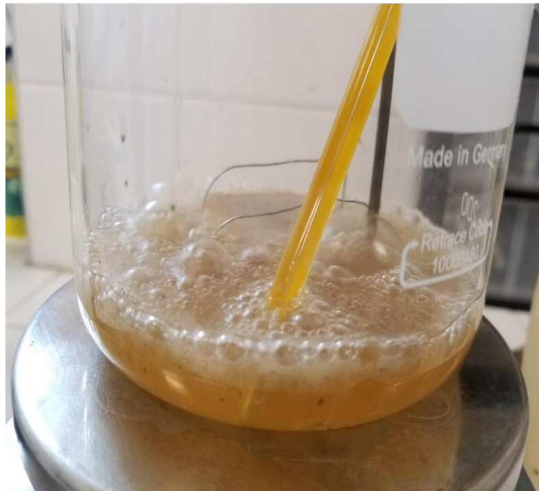
Figura B.1. Reacción inestable de peróxido de hidrogeno.
