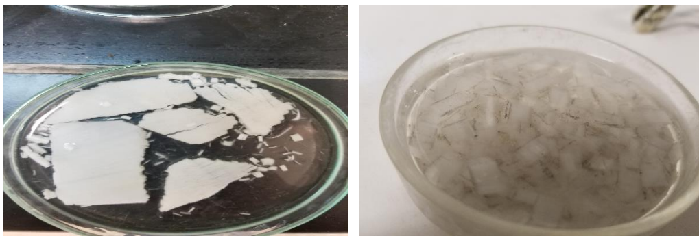
Figura 18. Muestra de madera roble, deslaminación en el proceso de blanqueo.
