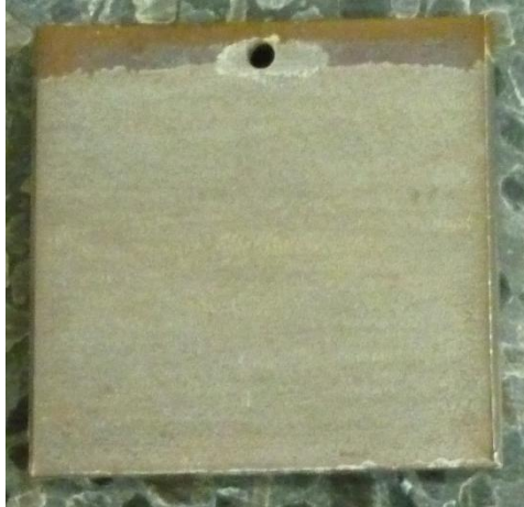
Acero inoxidable AISI-SAE 316 recubierto con \text{TiO}_2
