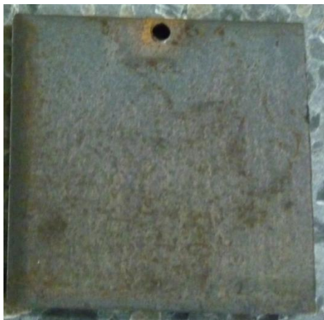
Cátodo platinizado de acero inoxidable AISI-SAE 316
