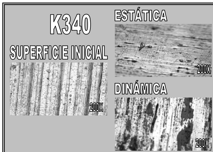
Figura 22. Superficies al inicio y al final del ensayo de desgaste, T de revenido 500°C.
