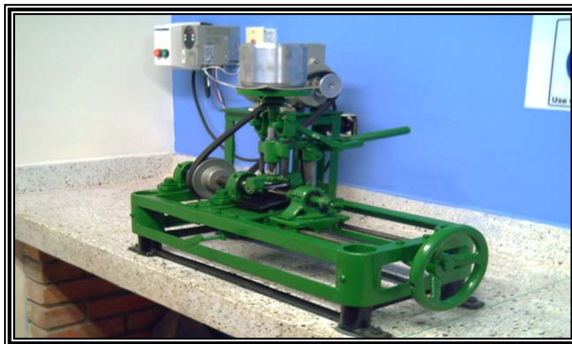
Figura 9. Máquina de cilindros cruzados para el ensayo de desgaste adhesivo., donde se puede observar el variador.
