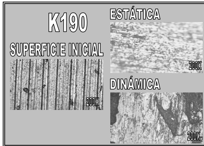
Figura 23. Superficies al inicio y al final del ensayo de desgaste, T de revenido 300°C.
