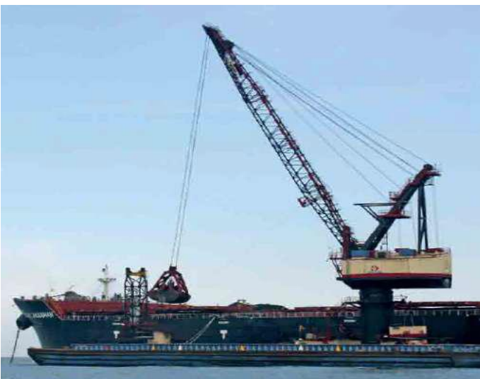
Figura 9. Cargue de Carbón desde la barcaza hasta el buque utilizando una grúa flotante
