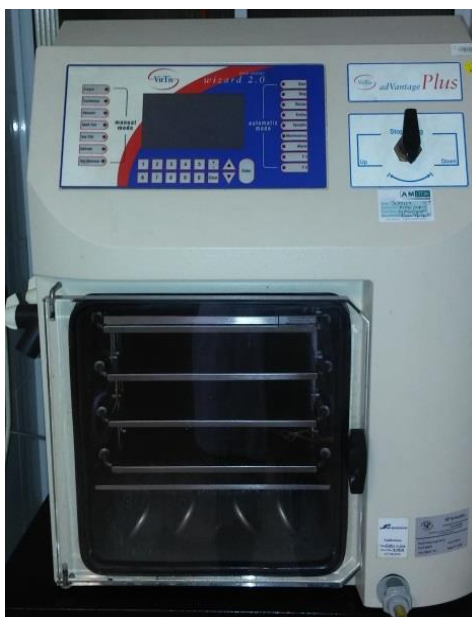
Figura 6. Liofilizador de bandejas Virtis Advance Plus (SP Scientific, New York, EE.UU.). Foto tomada por la autora. Lugar, CENIVAM-UIS, Bucaramanga.
