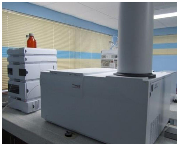
Figura 8. Cromatógrafo líquido acoplado a un espectrómetro de masas (TOF), por medio de una interface ESI. Foto tomada por Dra. Elena Stashenko. Lugar: CENIVAM-UIS, Bucaramanga.
