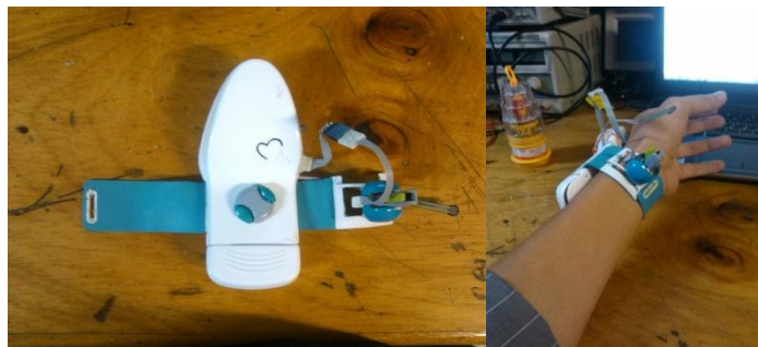
Figura 18. Aspecto final del dispositivo para tomar la señal de presión arterial.
