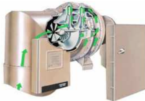
Figura 29. Compresor del chiller.
