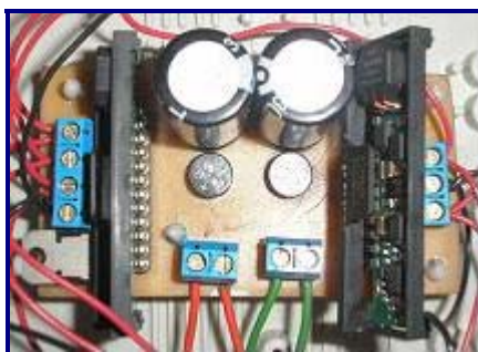
Figura 49. Implementación de la etapa de rectificación y alimentación.
