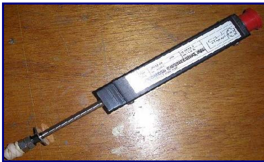
Figura 45. Sensor LVDT LP 802-50.
