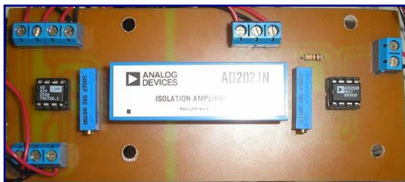
Figura 50. Implementación de la etapa de acondicionamiento de la señal del sensor, y aislamiento del circuito.
