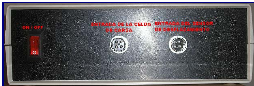
Figura 55. Encendido y Entrada de las Señales.
