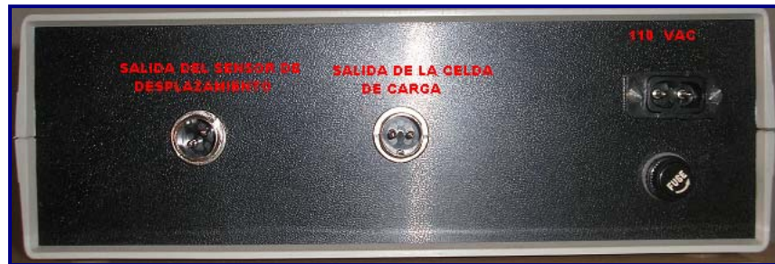
Figura 54. Alimentación y Salidas de las señales.
