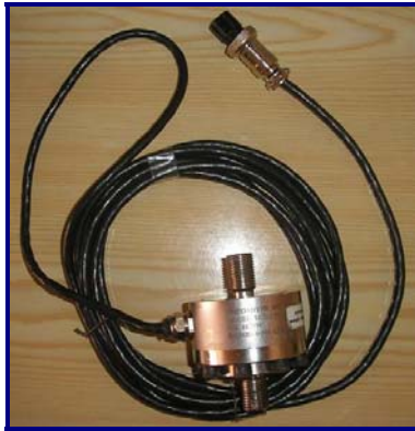
Figura 52. Celda de Carga LS203-500.
