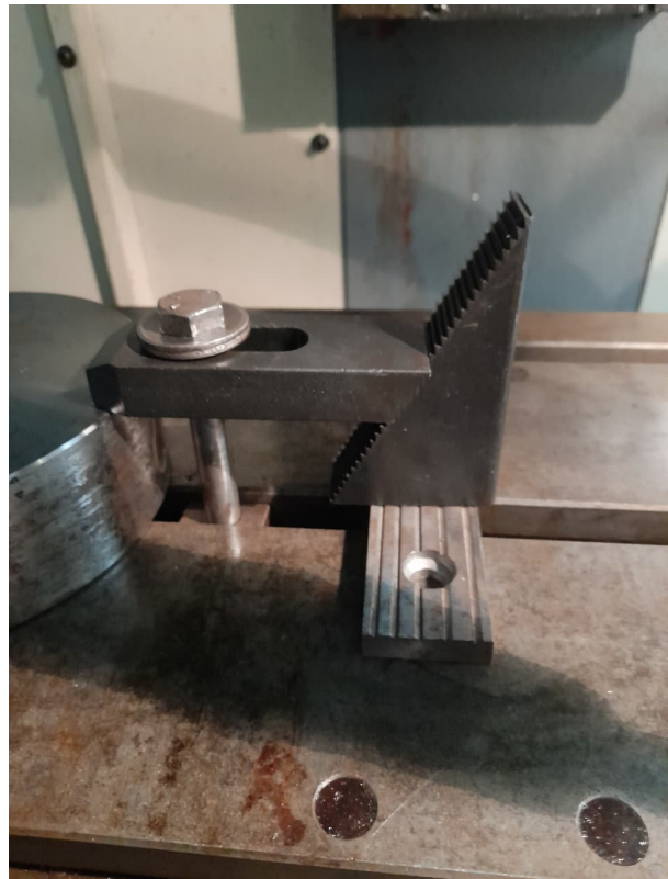
(b) Sujeción alternativa por bridas escalonadas.
