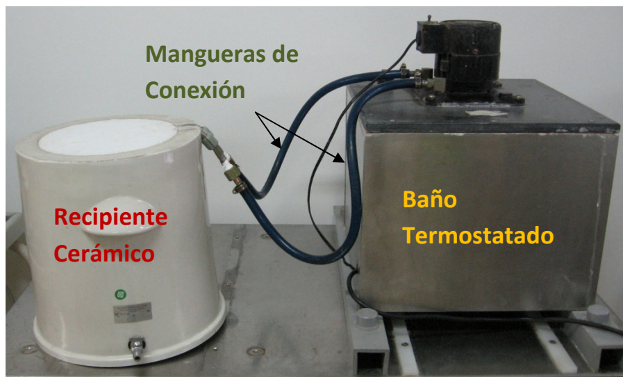
Figura 18. Montaje del sistema para mantener la temperatura de la solución
