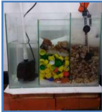
*Figura 7.* Filtro del sistema de recirculación
