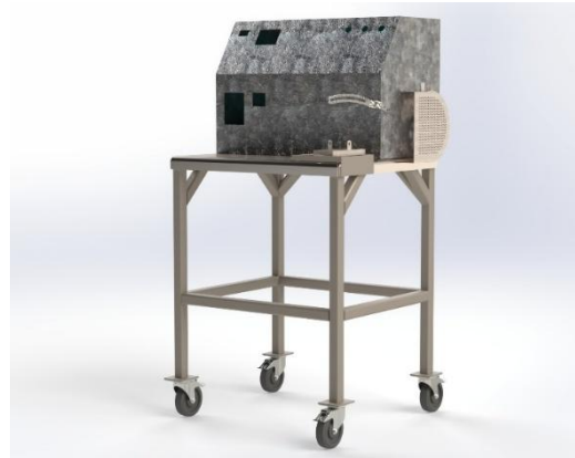
Figura 50. Modelo CAD banco de pruebas de alternadores de 12V.
