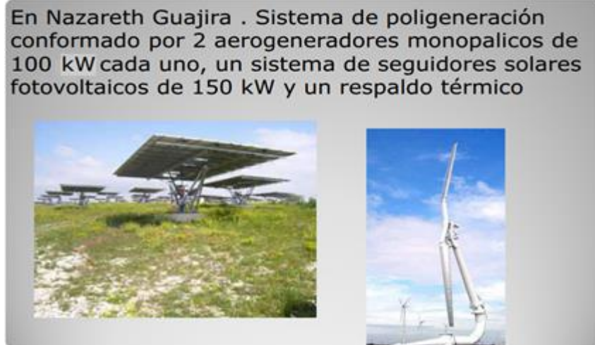
Figura 4 Sistema híbrido solar, eólica, térmica
