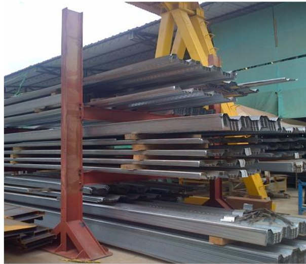
Figura 22. Dispositivo almacenamiento de Metaldeck
