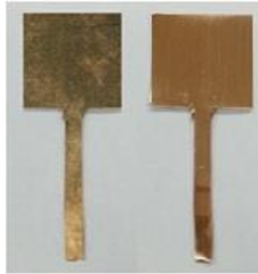
Figura 2. Sustratos de cobre antes y después de los tratamientos mecánico y químico.
