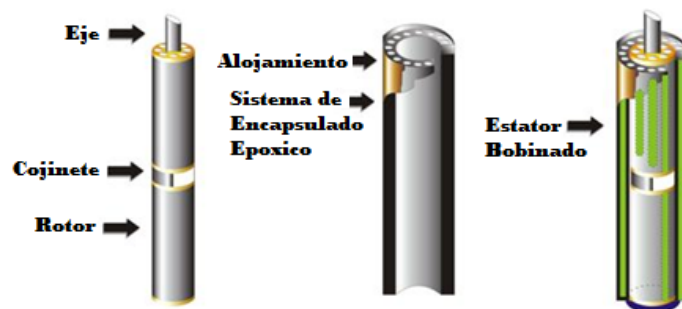
Figura 11. Esquema del Rotor y Estator.
