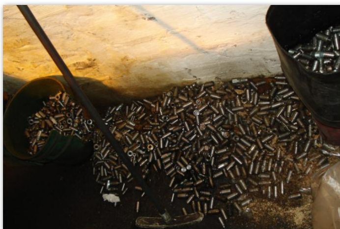
Ilustración 98. Producto defectuoso en el piso, almacenado en malas condiciones.
