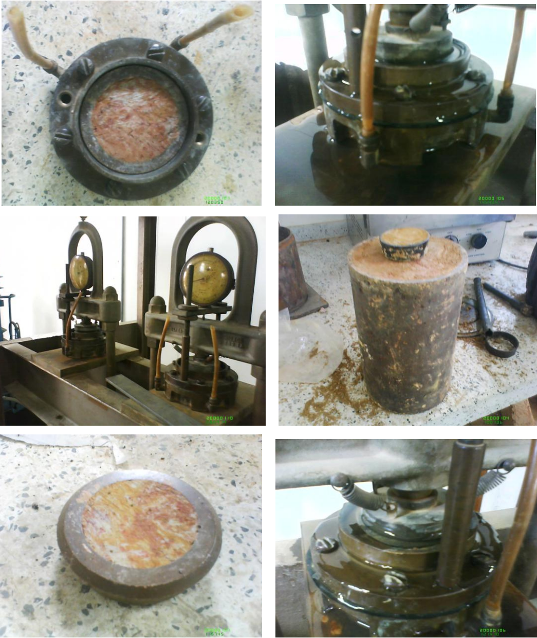
Figura 16. Prueba de expansión en consolidometro
