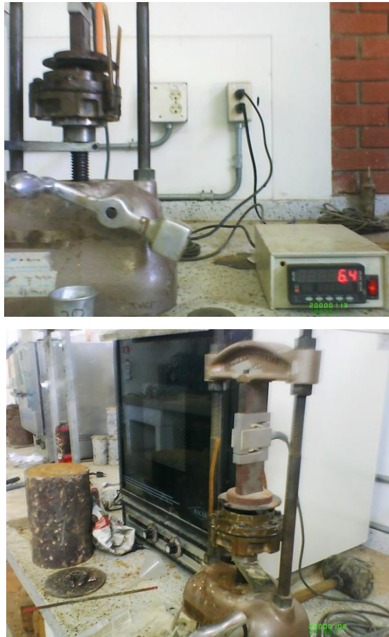
Figura 18. Maquina utilizada para Prueba de presión de expansión
