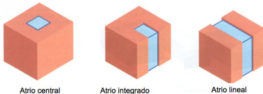
Figura 3. Esquemas de organización del atrio en el edificio
