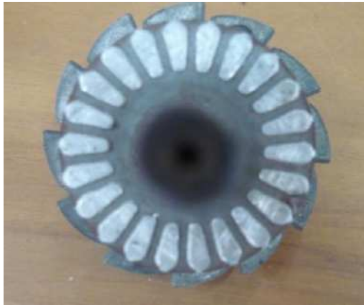
Figura 3.37. Sección transversal del rotor del motor.
