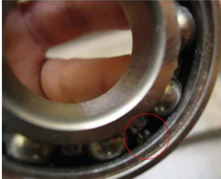
Figura 3.58. Falla rayado moderado.
