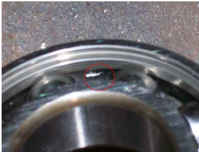
Figura 3.57. Falla rayado superficial.
