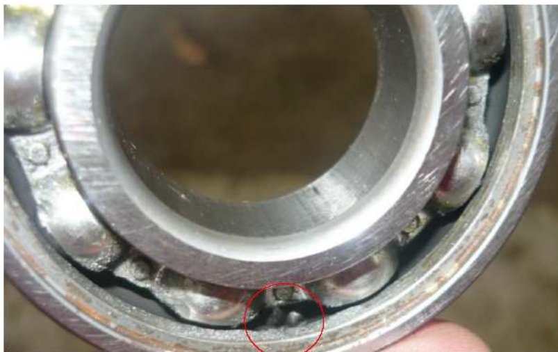
Figura 3.59. Falla rayado profundo.
