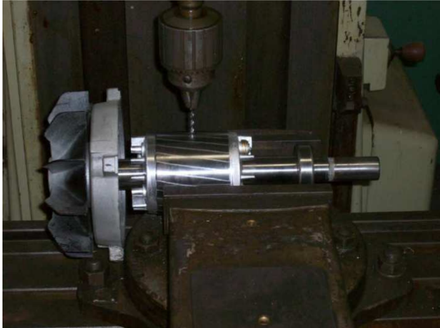
Figura 3.38. Rompimiento de las barras del motor.
