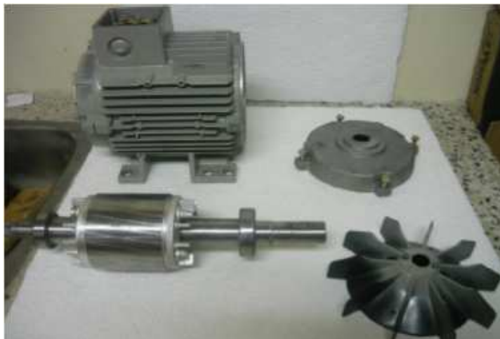
Figura 1.2. Motor de inducción trifásico jaula de ardilla.
