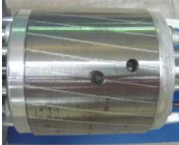
Figura 3.40. Rotor con dos barras rotas.
