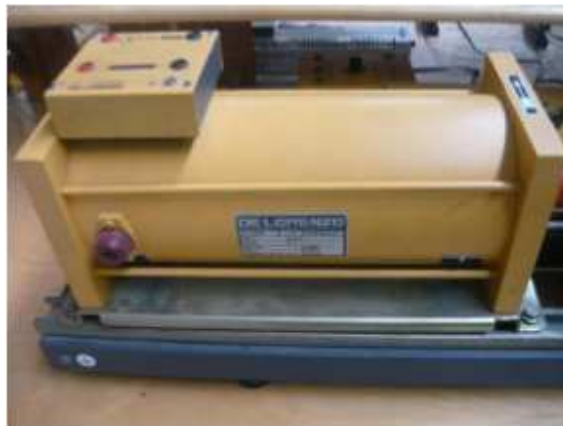
Figura 2.3. Máquina de corriente continua.
