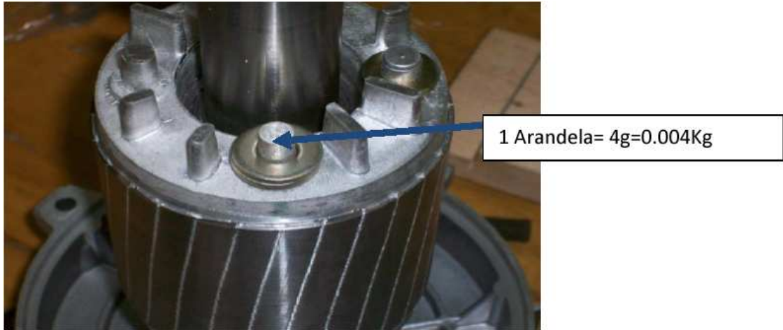
Figura 3.22. Arandelas para inducir la falla.
