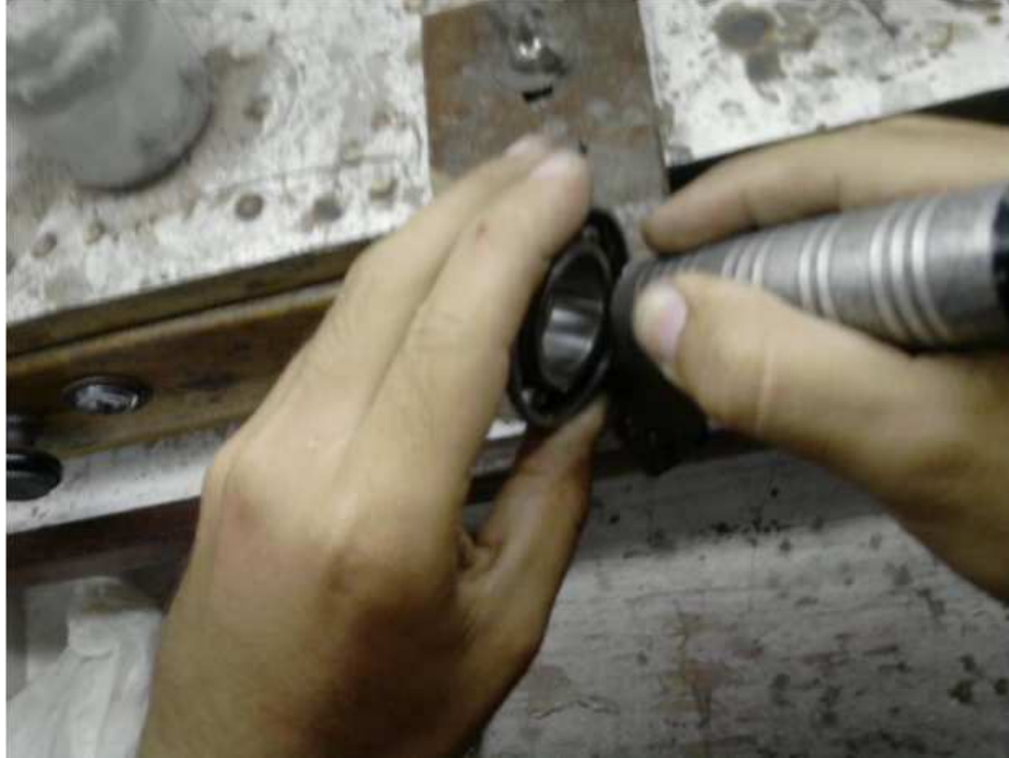
Figura 3.56. Inducción de la falla en la pista externa del rodamiento.
