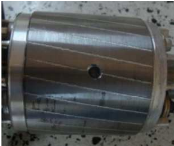
Figura 3.39. Rotor con una barra rota.
