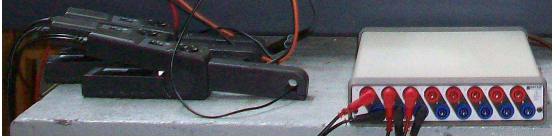
Figura 2.5. Sistema de adquisición de datos.
