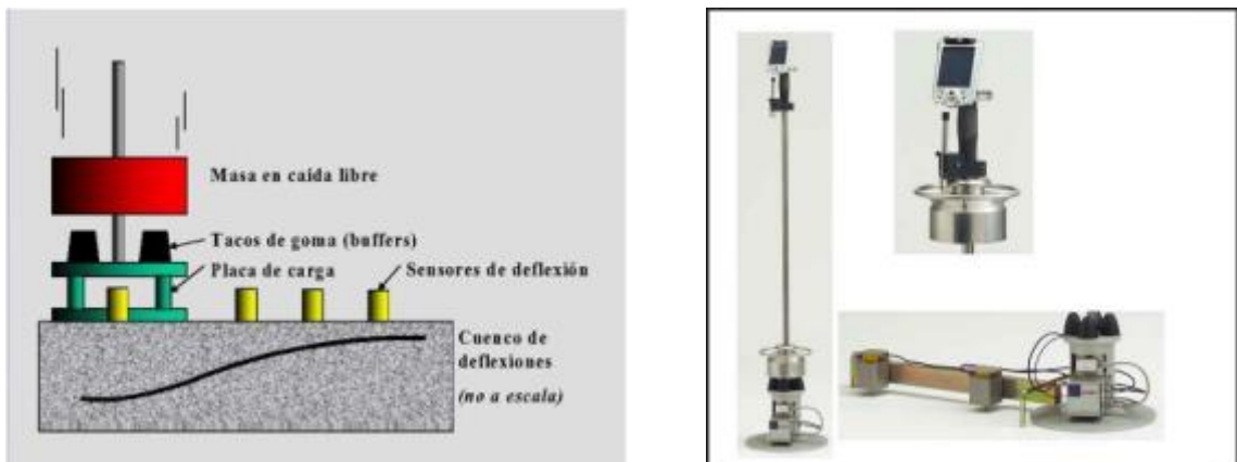
Imagen 26: Esquema básico del equipo y funcionamiento del LWD
