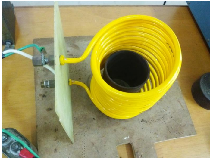
Figura 44. Tubo de acero dentro del solenoide
