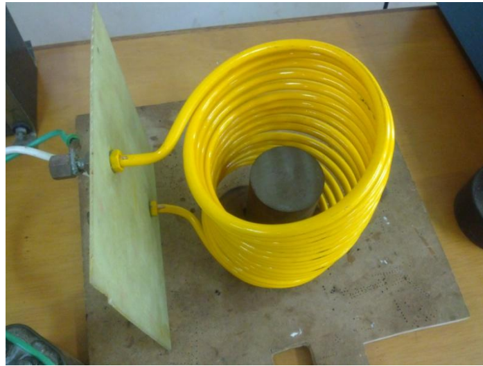
Figura 48. Barra de acero dentro del solenoide
