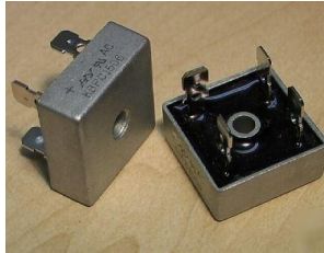
Figura 11. Rectificador de 600 V a 15 A
