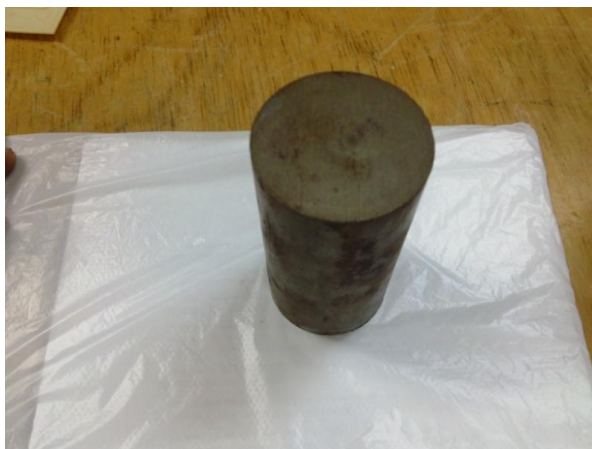
Figura 43. Barra de acero 1045
