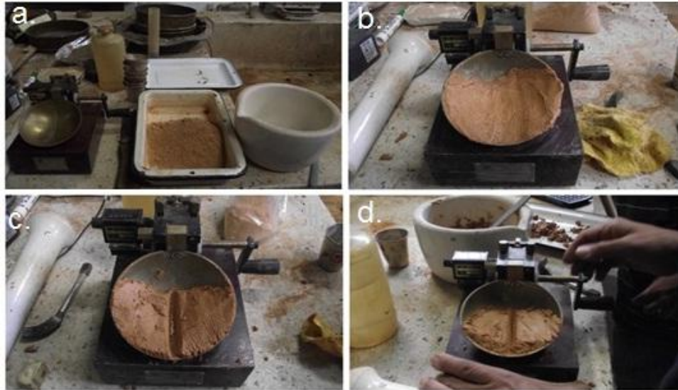
Figura 11. Ensayo de determinación de límite líquido para la muestra de suelo. (a). materia prima utilizada con diámetro inferior a 1/2 mm. (b). elaboración de pasta homogénea y colocación en la capsula. (c). se divide la pasta en dos partes por medio del acanalador. (d). unión de la pasta después de los golpes.
