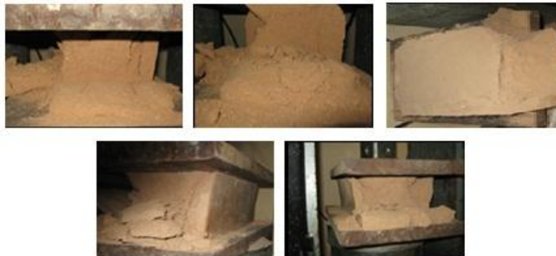
Figura 59. Ensayos de compresión para las 5 unidades de adobes de la mezcla 1.
