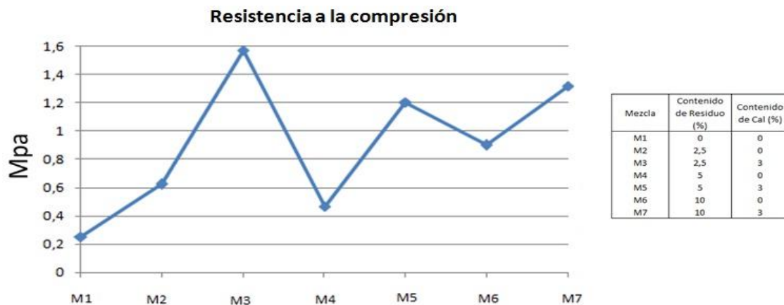
Figura 66. Resultados promedio de resistencia a la compresión
