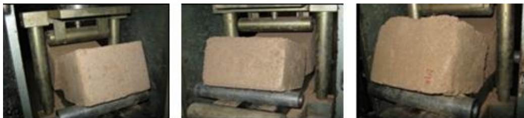
Figura 72 . Ensayo de Flexión para la mezcla 6.
