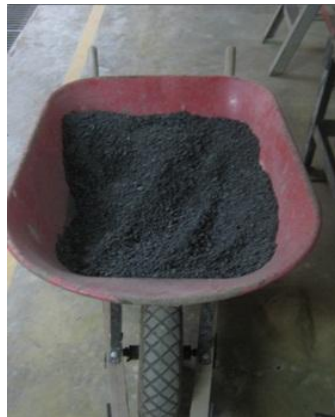
Figura 16. Material triturado en la trituradora de mandíbulas BB 200 RETSCH.
