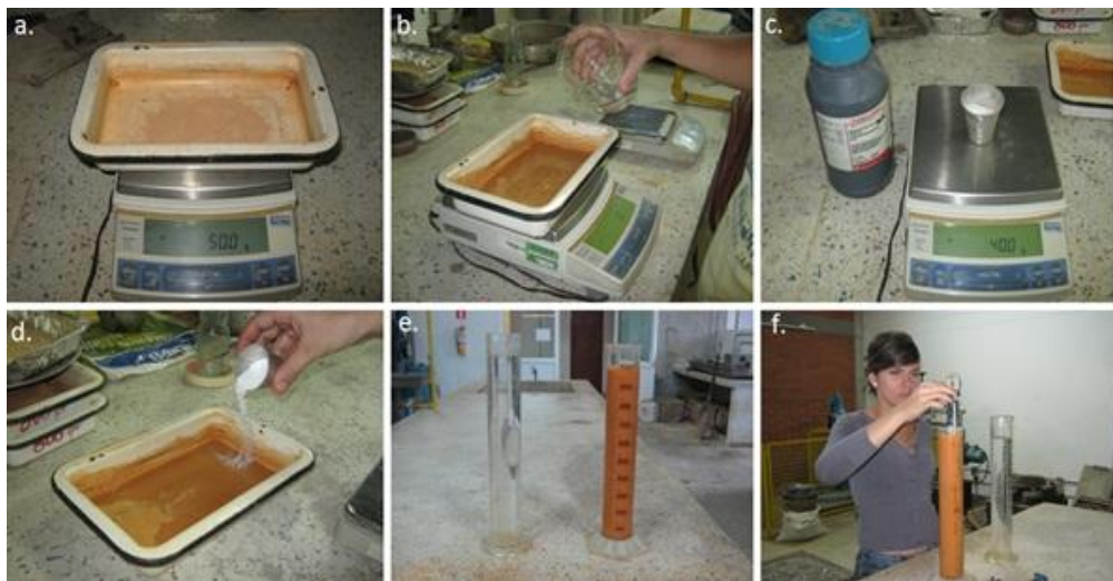
Figura 10. Prueba de determinación de materiales finos por Hidrometría. (a) 50 gramos pasa tamiz 200. (b) Dilución en agua destilada. (c) 40 gramos de Hexametáfosfato de sodio. (d) Mezcla de componentes y reactivos. (e) Probetas con soluciones: una con agua destilada (izq.) y otra con la mezcla de suelo y reactivo (der.). (f) Medición del Hidrómetro.
