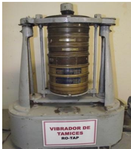
Figura 8 . Vibrador de Tamices. Tamizador Mecánico RO-TAP Testing Sieve Shaker, serial No. 21707.
