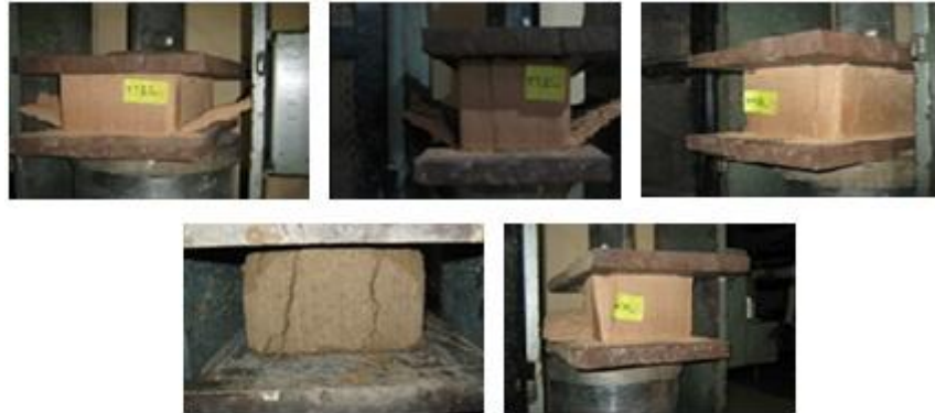
Figura 60. Ensayos de compresión para las 5 unidades de adobes de la mezcla 2.
