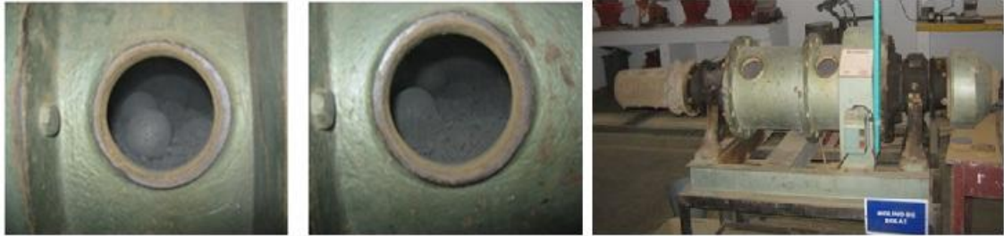
Figura 17. Molino de Bolas Denver.
