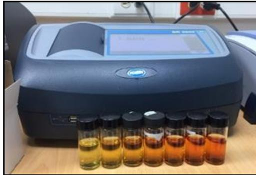
*Figura 26.* Espectrofotómetro y diluciones usadas
