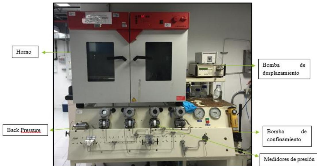
Figura 15. Equipo de desplazamiento (1)
