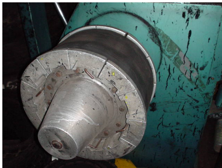
Figura 15. Cono expandible en reposo
