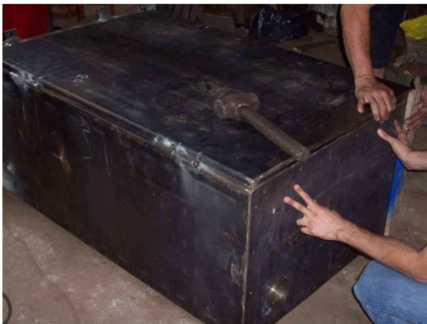
Figura 79. Cabina donde se ubicara el mecanismo de la llanta (cono expandible)
