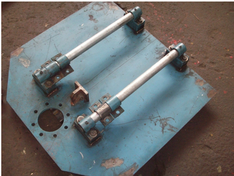
Figura 72. Segunda mesa con las barras y cojinetes que serán de apoyo para la tercera mesa.
