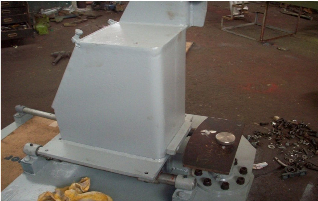
Figura 93. Ensamble del eje de raspado
