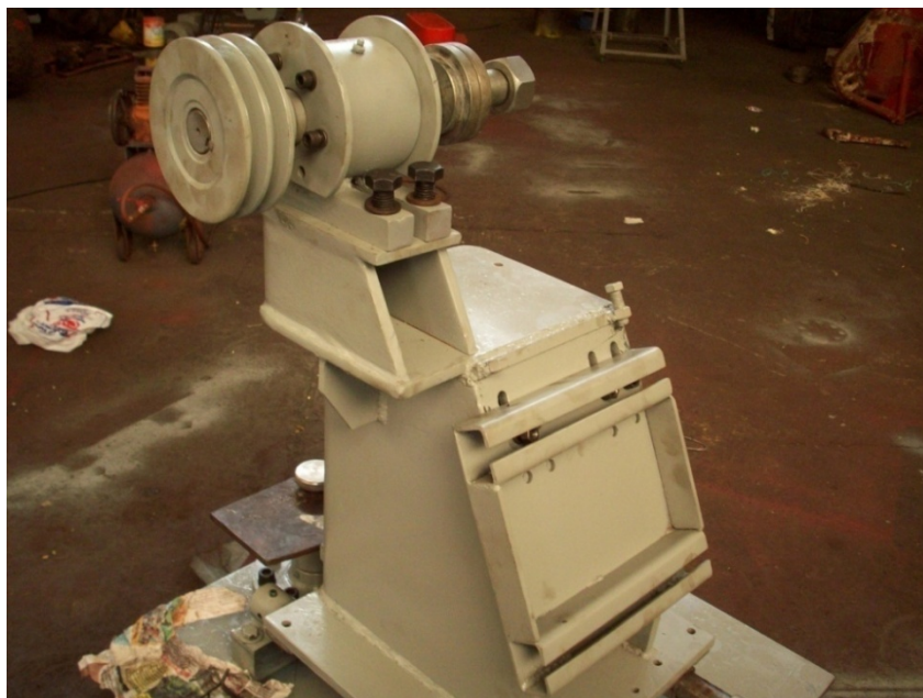
Figura 97. Ensamble del motoreductor en la cabina para el cono expandible.
