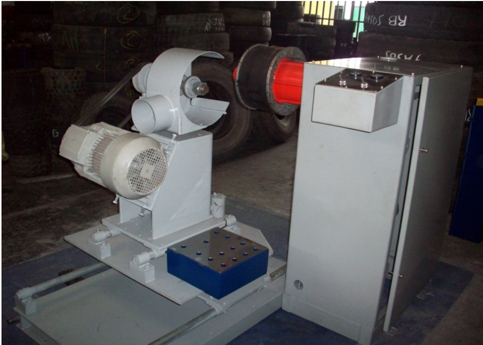
Figura 103. Vista general de la maquina raspadora de llantas.
