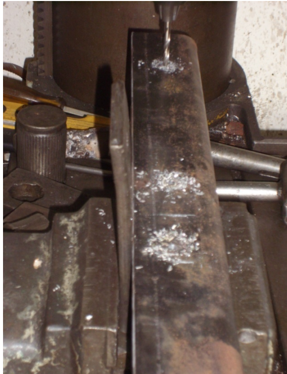
Figura 70. Mecanizado en el perfil base
