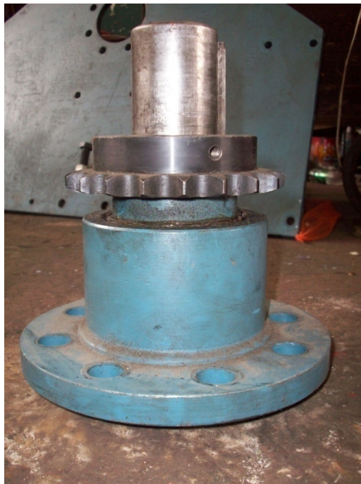
Figura 73. Eje pivotante de la mesa.
