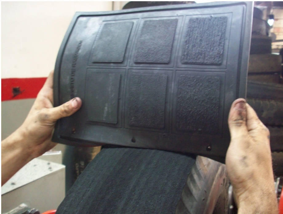
Figura 106. Rugosidad de la base de la llanta.
