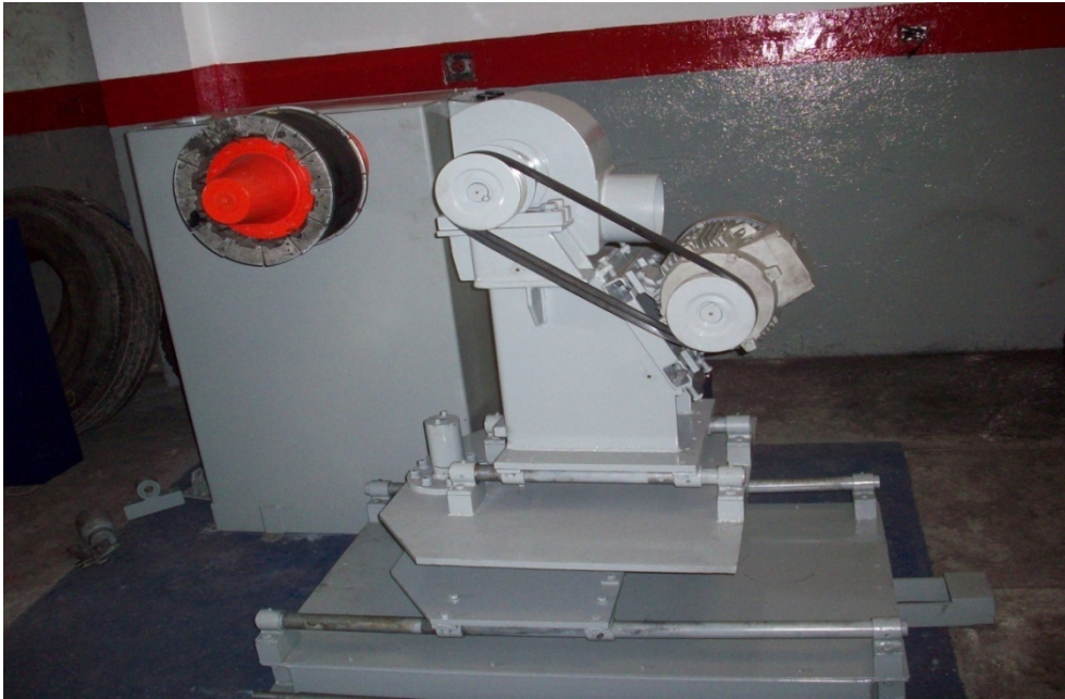
Figura 101. Montaje general del sistema de raspado y sistema de soporte de la llanta
