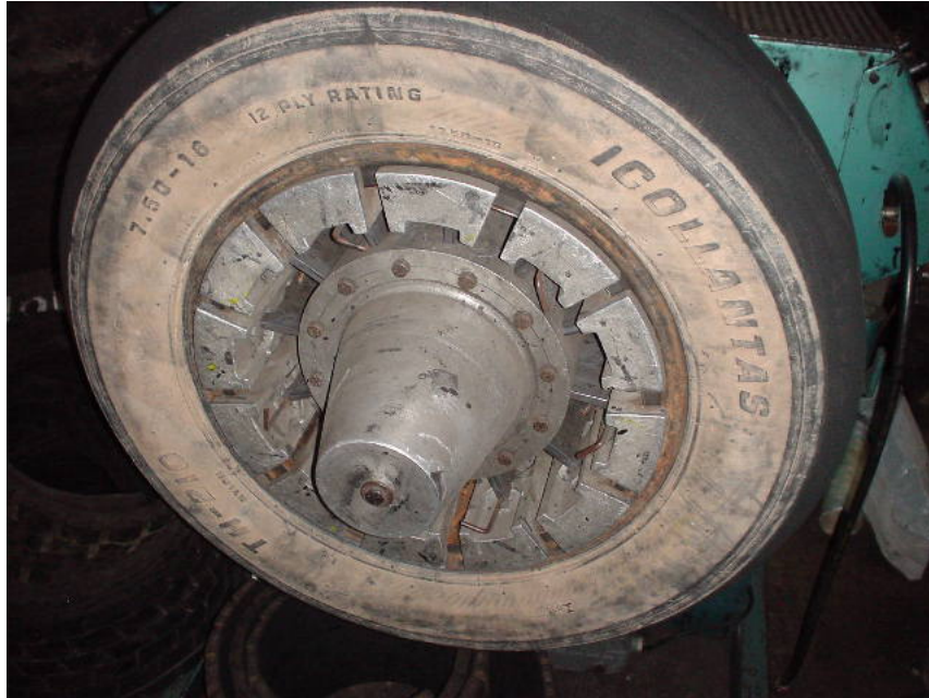
Figura 16. Cono expandible realizando trabajo
