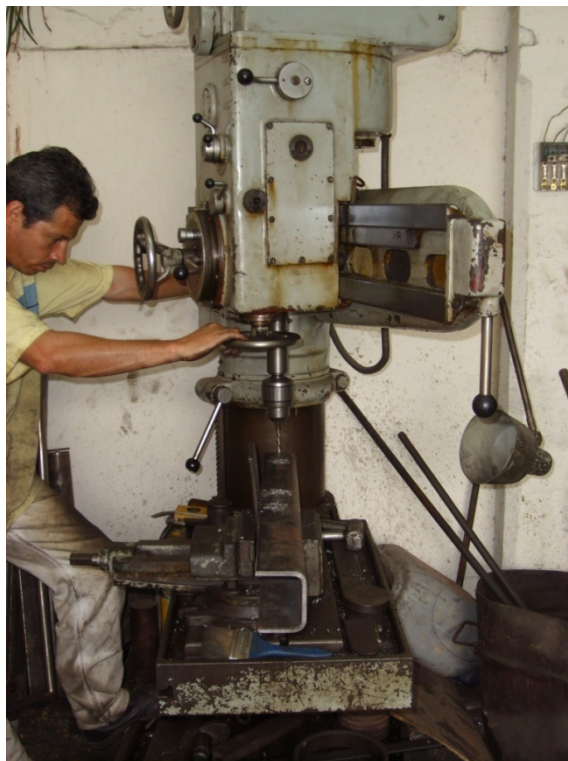
Figura 70. Mecanizado en el perfil base
