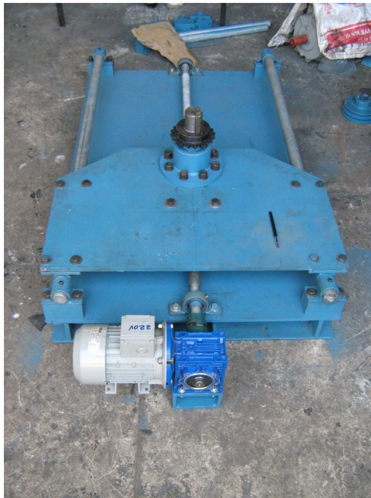
Figura 75. Pre-ensamble de la base con la primera mesa.
