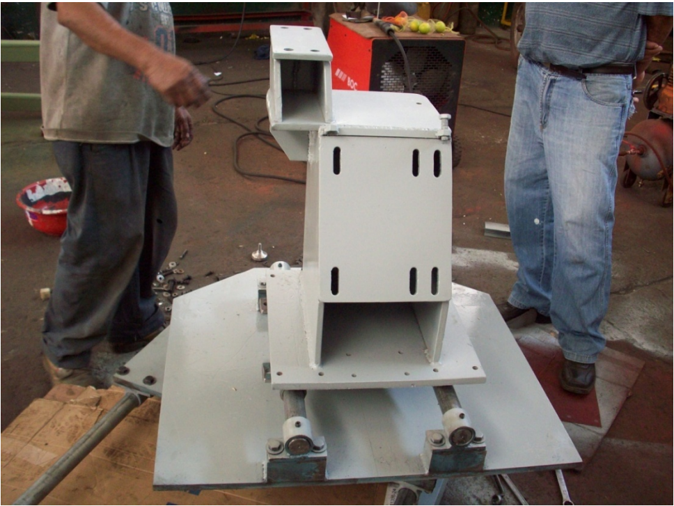
Figura 91. Estructura del motor y tambor sobre la tercera mesa.
