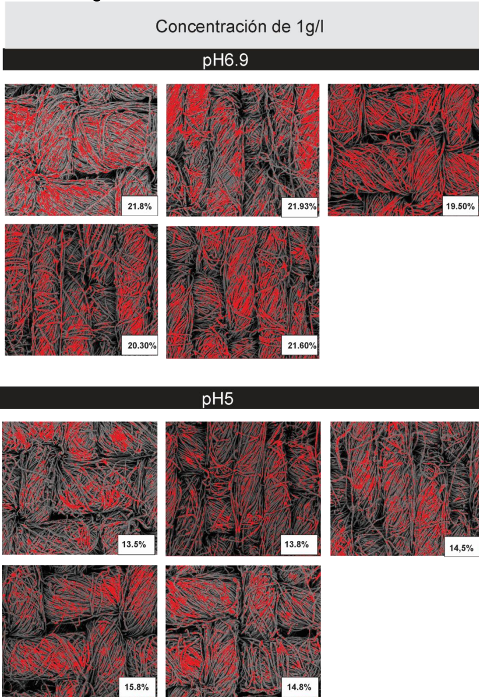
Figura C 1. Micrografías SEM a 400\mu\text{m} para el estudio de áreas recubiertas por el software ImageJ .
