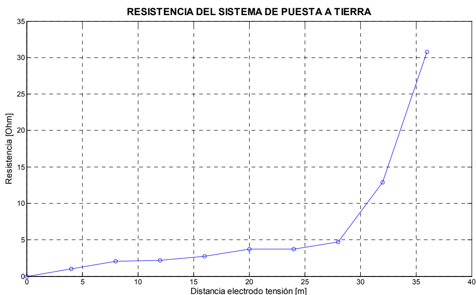
Figura 3.107. Resistencia del sistema de puesta a tierra, subestación Coliseo
