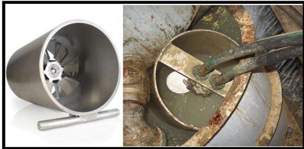
Figura 19. Mezclador de lodos. Fuente. Departamento de operaciones.
