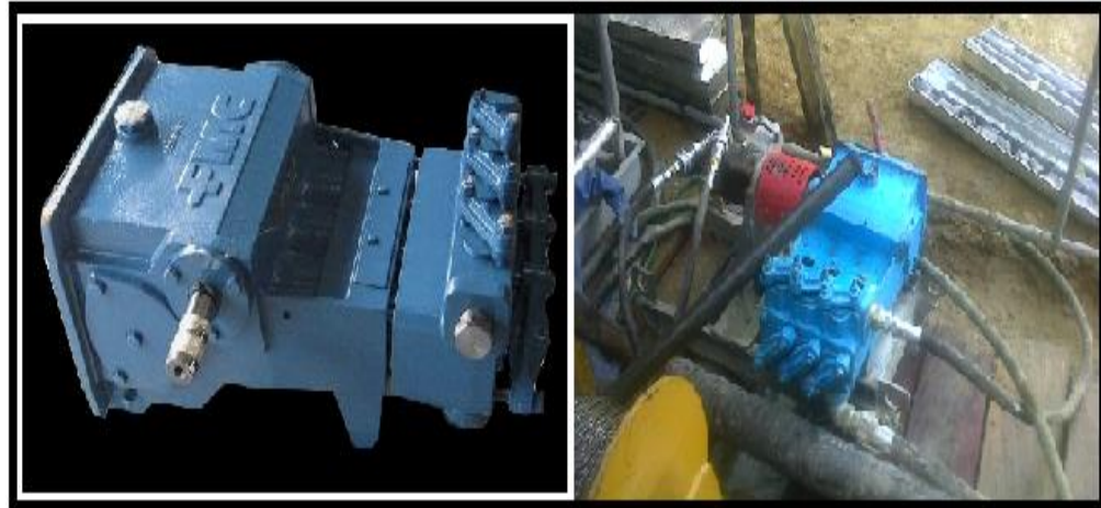
Figura 21. Bomba hidráulica FMC. Fuente. Departamento de operaciones.
