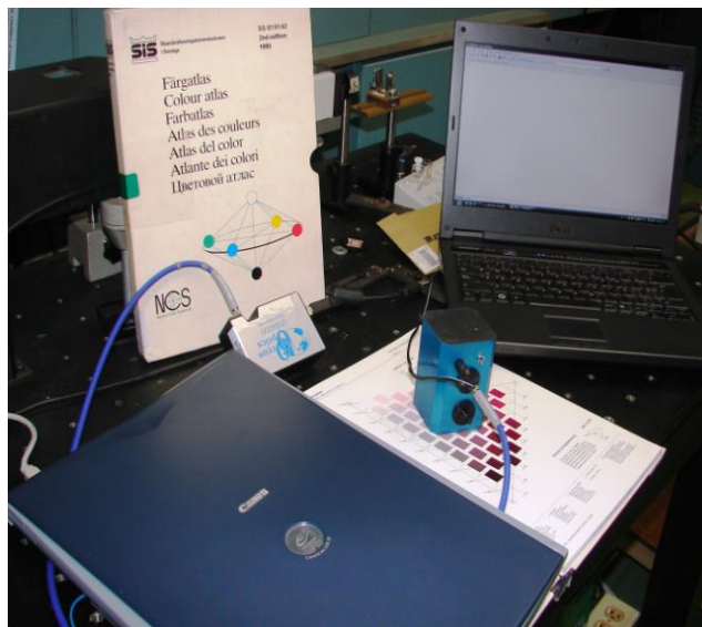
Figura 11. Montaje del espectrofotómetro y esfera integradora.
