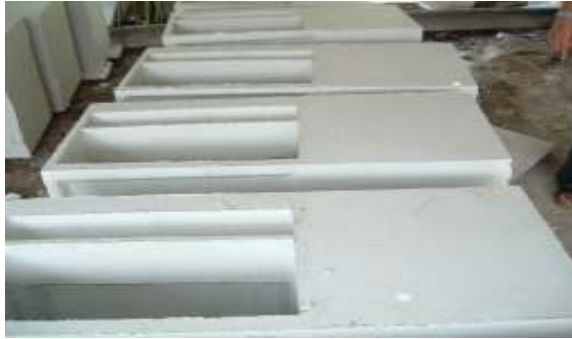
Figura 15: Bodega secado de lavaderos
