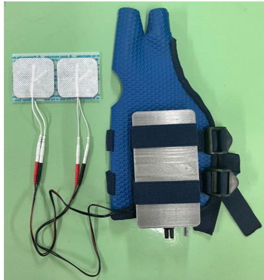
Fig3. Prototipo de guante biónico
