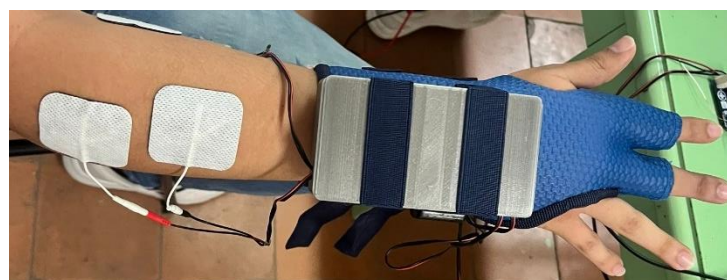
Fig2. Prototipo de guante biónico sobre el paciente
