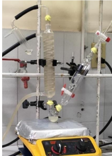
Figura 4. Montaje empleado para la síntesis del LI [BMIM][NTf 2 ]
