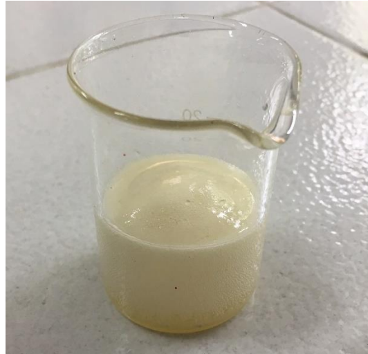
Figura 5. Espuma con líquido iónico en proceso de crecimiento.
