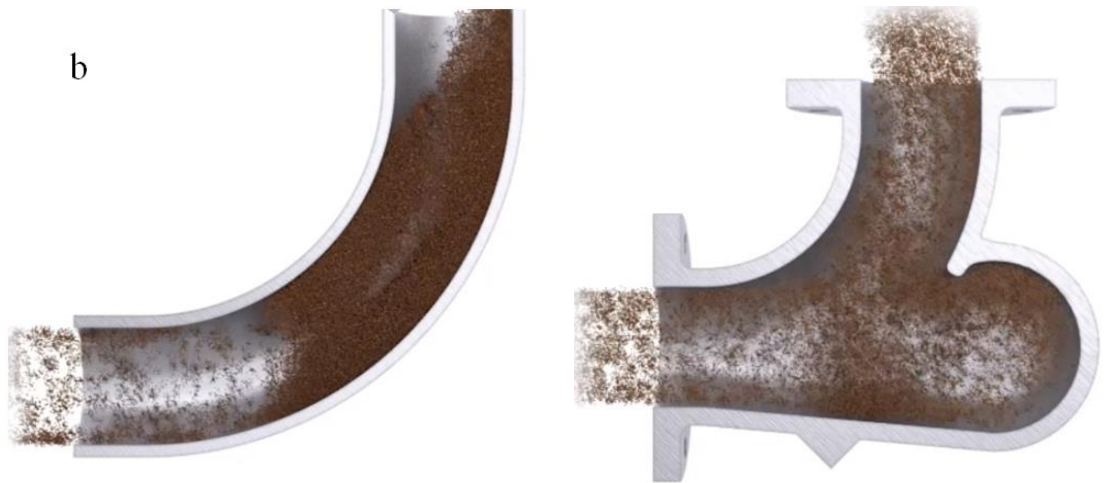
Figura 12. Ventajas de utilizar una tubería con cámara de vórtices, a) Mitigación de erosión y b) Prevención de taponamientos. HAMMERTEK.
