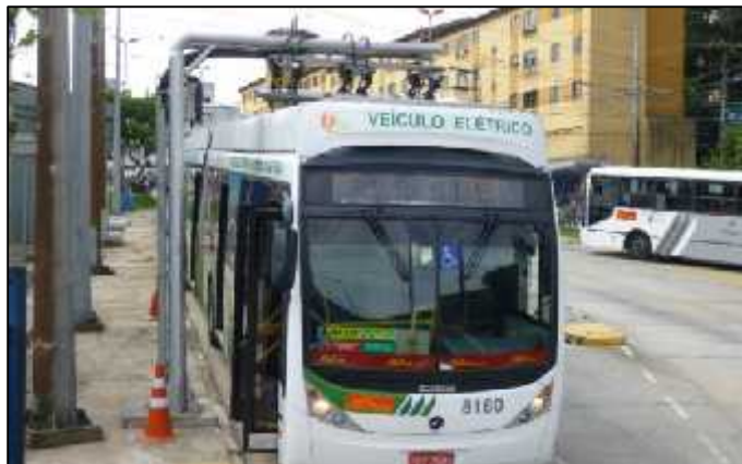
Figura 13. Bus eléctrico con recarga de oportunidad en ruta
