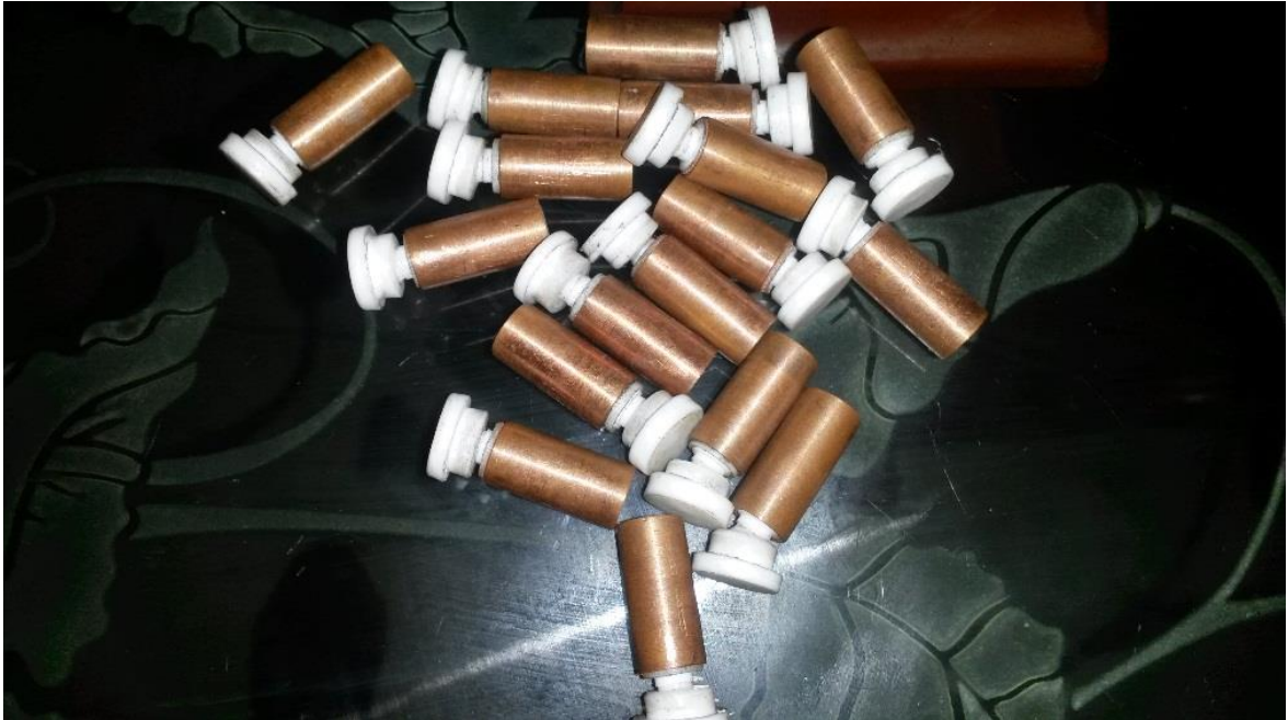
Figura 81. Pistones deslizantes en teflón recubiertos de cobre.
