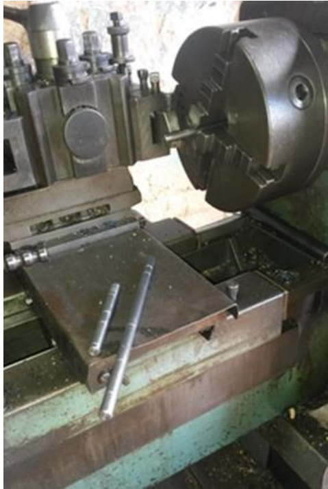
Figura 71. Mecanizado de ejes en un torno.
