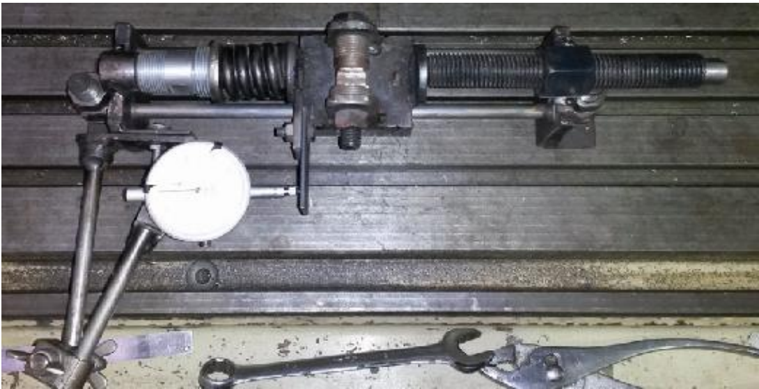
Figura 23. Banco de prueba para la toma de datos. Fuerza de compresión en el resorte (longitud solida).
