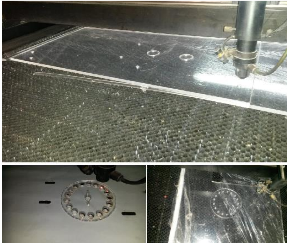
Figura 85. Corte de acrílico en una cortadora laser.
