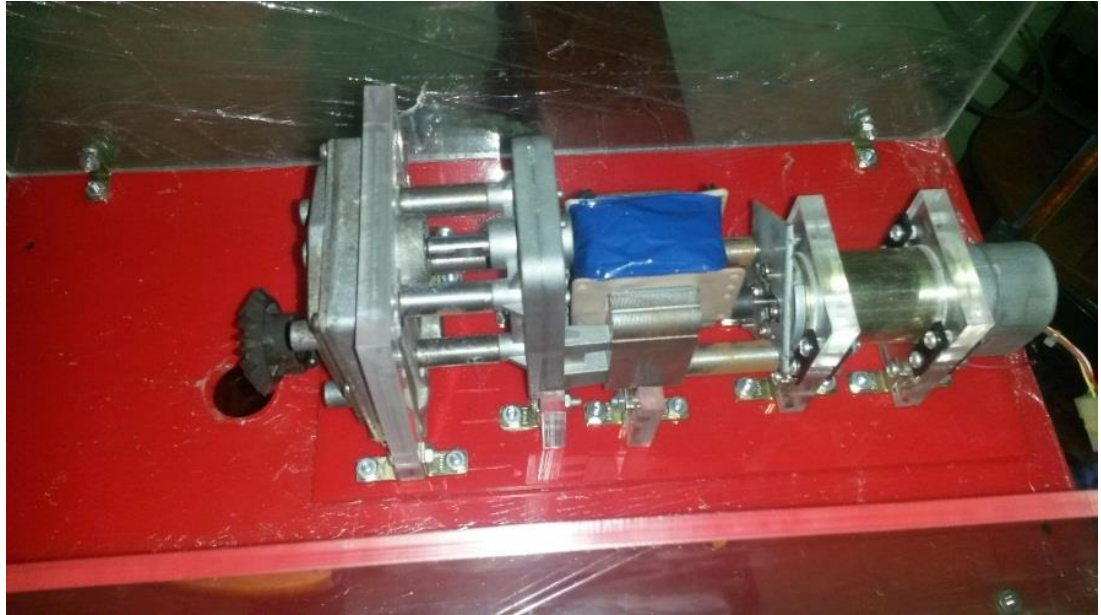
Figura 76. Motor reductor completamente finalizado el cual baja la velocidad de 3680 rpm a tan solo 0,36 rpm.
