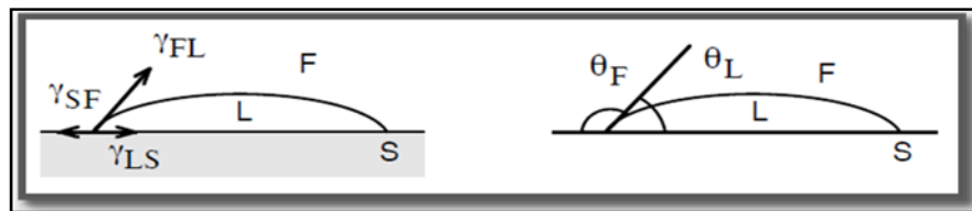
Figura 1. Diagrama de contacto trifásico solido-líquido-fluido.
