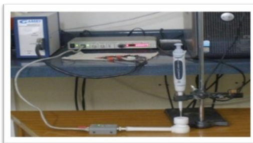
Figura 4. Montaje para determinación de ángulos de contacto con QCM.
