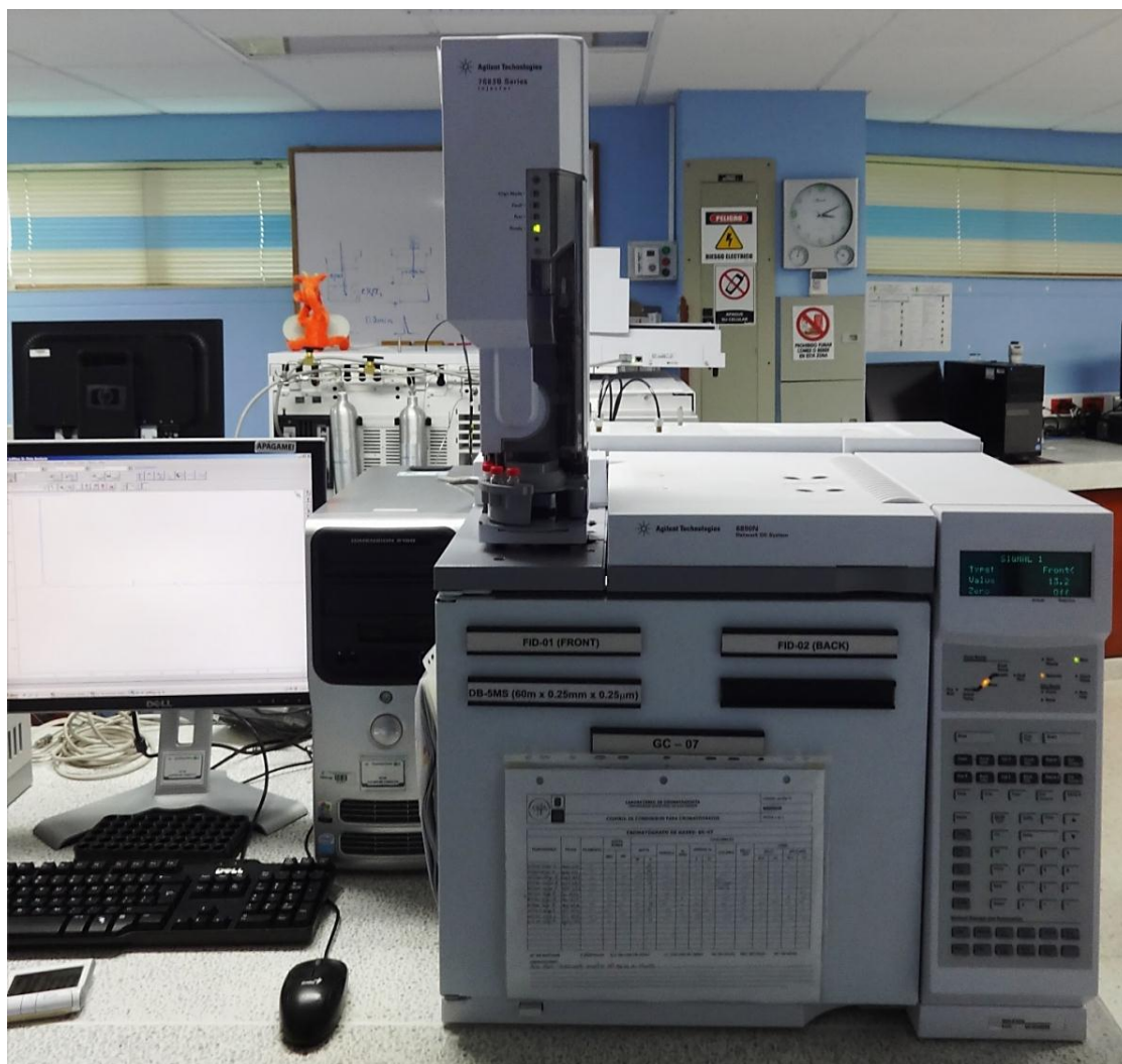
Figura 6. Equipo de GC-FID utilizado en el presente trabajo. Fotografía tomada por el autor en el Laboratorio de Cromatografía y Espectrometría de Masas CROM-MASS, UIS – Bucaramanga, el 28 de agosto de 2014.
