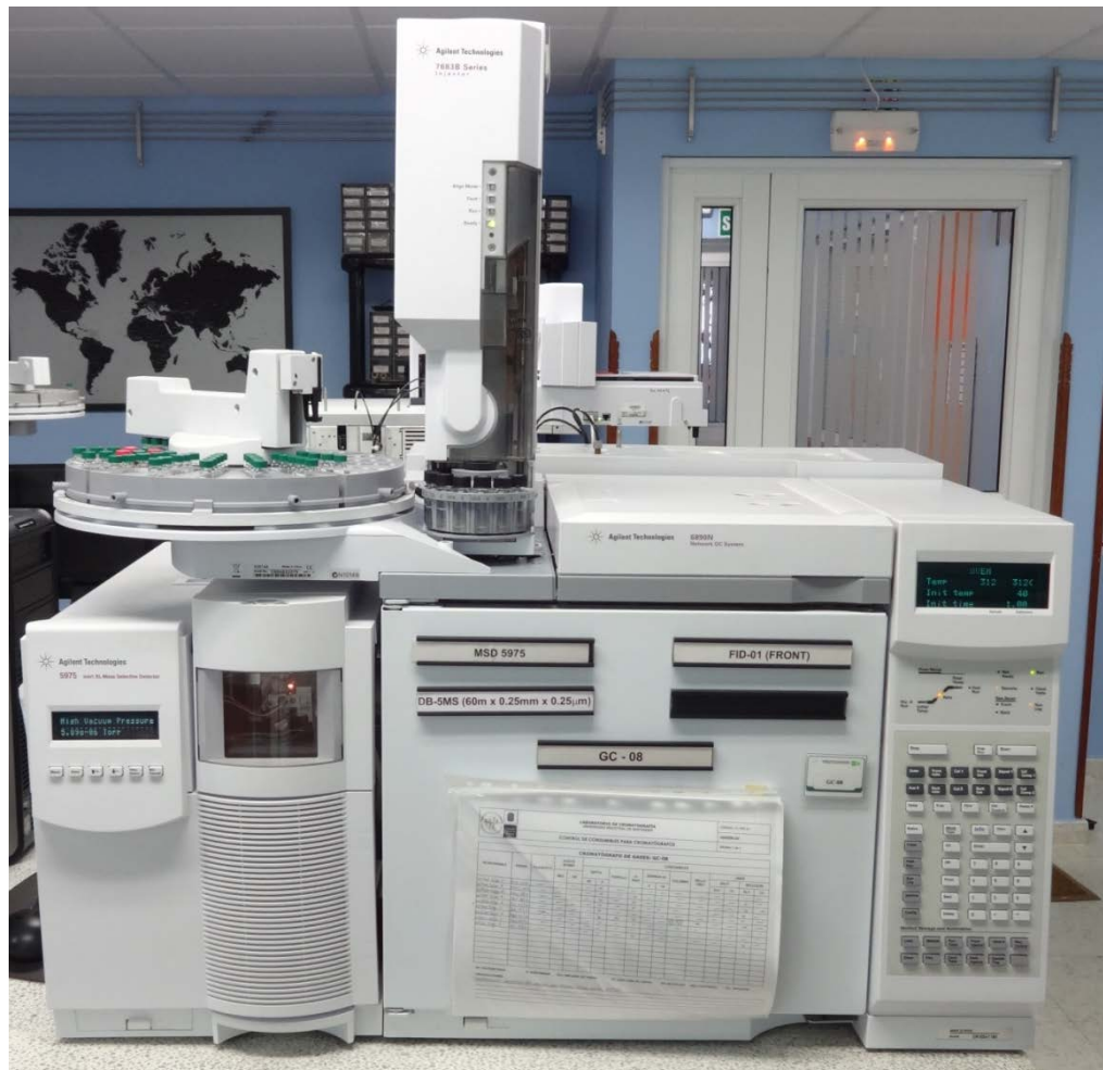
Figura 5. Equipo de GC-MS utilizado en la investigación. Fotografía tomada por el autor en el Laboratorio de Cromatografía y Espectrometría de Masas CROM-MASS, UIS – Bucaramanga, el 23 de agosto de 2014.
