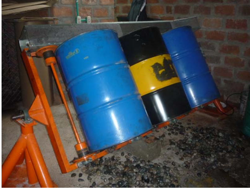
Figura 4. Tambor metálico en proceso de limpieza interior en cadeneadora.
