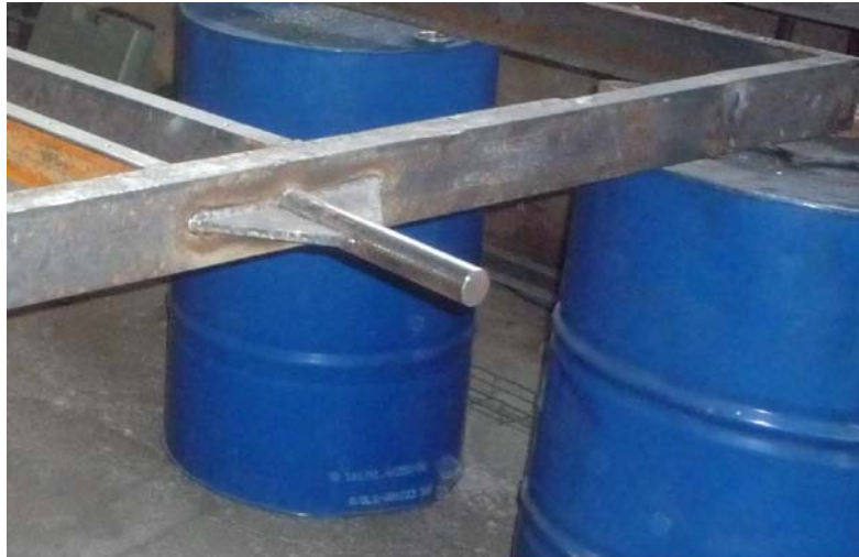
Figura 26. Eje de rotación en estructura metálica.
