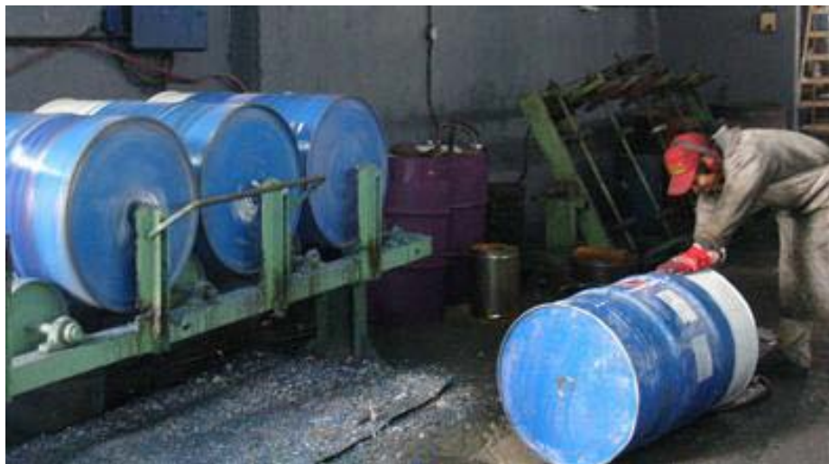
Figura 4. Tambor metálico en proceso de limpieza interior en cadeneadora.
