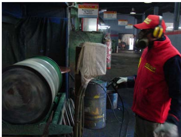
Figura 5. Tambor metálico en proceso de pintura.
