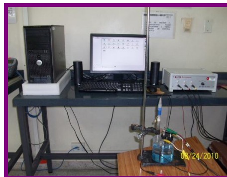
Fotografía 3. Montaje de la celda (a) – Conexión del bipotenciostato (b)
