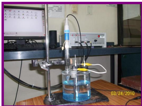
Fotografía 3. Montaje de la celda (a) – Conexión del bipotenciostato (b)
