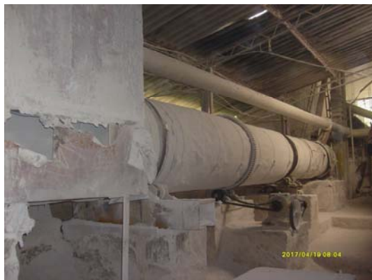
Figura 8b. Horno rotario ubicado en la planta productora de yeso INYESA Ltda.
