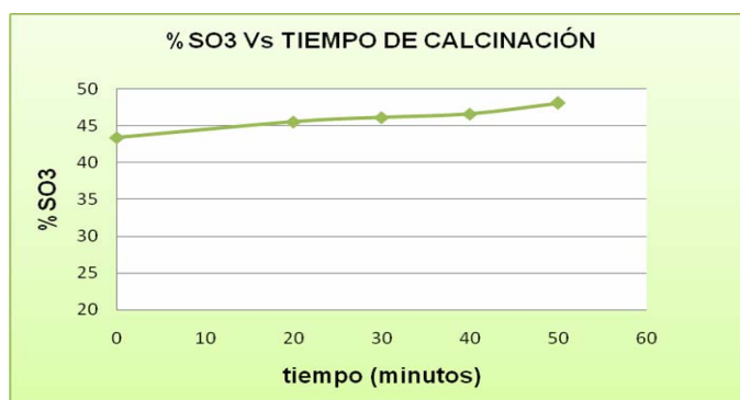
Figura 23. Porcentaje de SO 3 Vs. Tiempo de Calcinación (T= 110°C)
