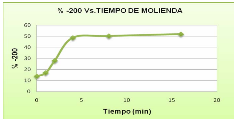
Figura 25. Variación del porcentaje de mineral pasante en malla 200m Tyler respecto al tiempo de molienda
