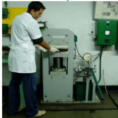
Prensado temperatura ambiente (23 +/- 2 °C)
