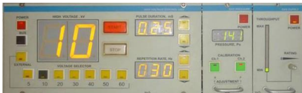
Figura 13. Proceso de implantación iónica con voltaje a 10 KeV.
