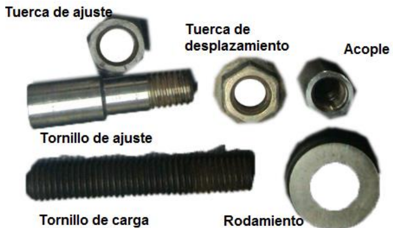
Figura 18. Accesorios de los anillos tensores.
