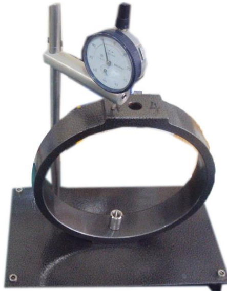
Figura 17. Anillo tensor con su comparador de carátula
