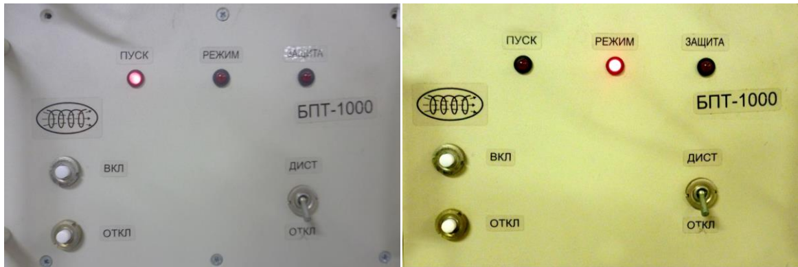
Figura 10. Proceso de alto vacío. Iniciando el alto vacío (izquierda), indicación de alto vacío en la cámara de descarga (derecha).
