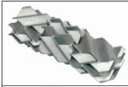
Tipo V. Platos corrugados a 45° o 30° del eje de la tubería con elementos de mezclado adyacentes a 90°.
