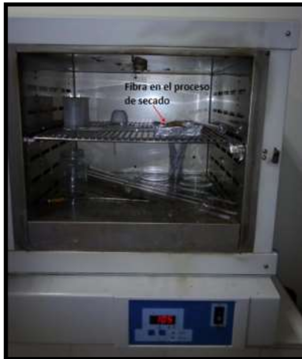
Figura 21. Horno empleado en la realización del proyecto.
