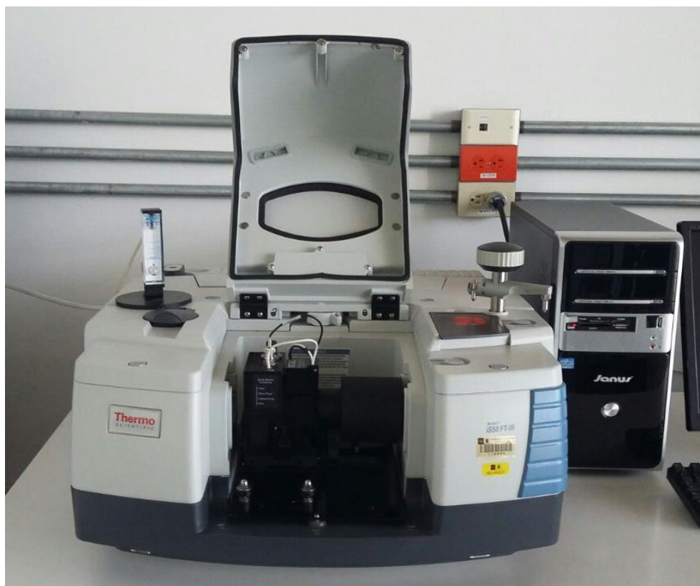
Figura 4. Celda fotoacústica acoplada al espectrofotómetro, vista exterior
