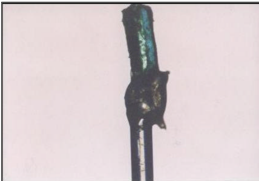
Figura 38. Monocristal montado en capilar (V/P=0.5).
