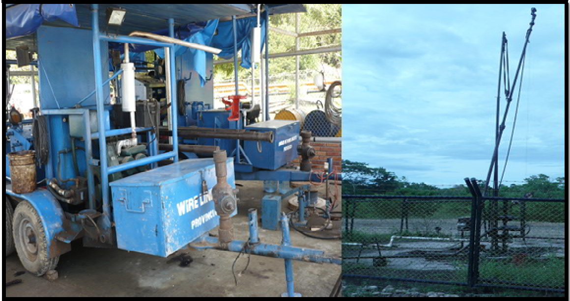
Imagen 2. Equipo de Slick Line Propiedad de Ecopetrol Superintendencia de Operaciones De Mares.
